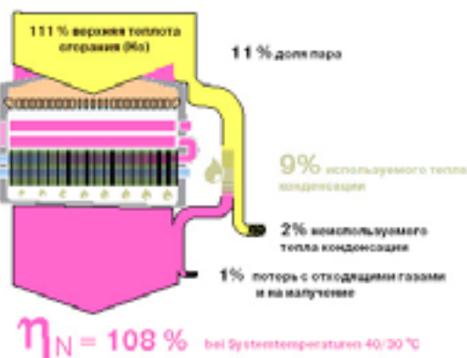
Рис. 6: КПД современного конденсационного котла при работе в системе отопления 40/30 °C.
